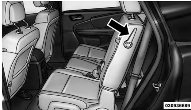
Tip 'n Slide™ Control Lever
