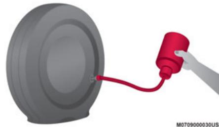
**Squeeze Sealant Into Tire**
