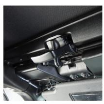
**Header Latch Disengaged**
