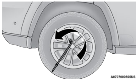
Loosen Lug Nuts
