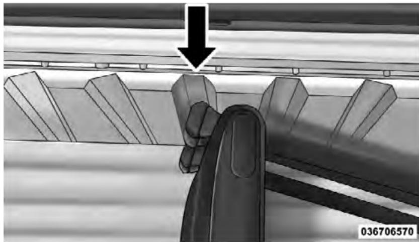
**Aligning Gate To Slots**
