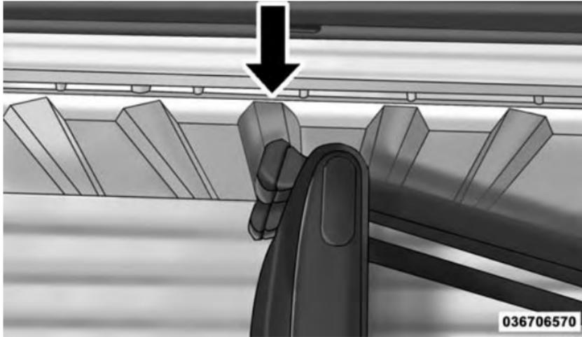
**Aligning Gate To Slots**
