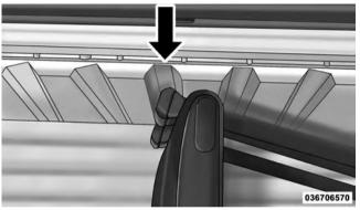
**Aligning Gate To Slots**
