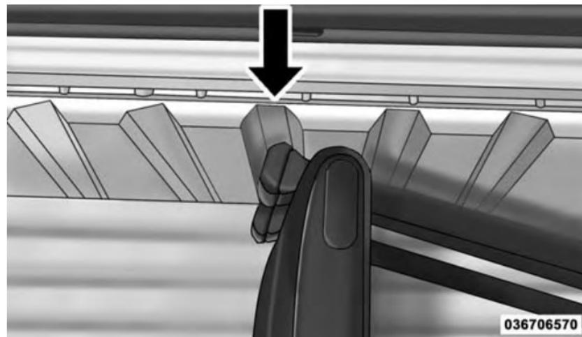
**Aligning Gate To Slots**
