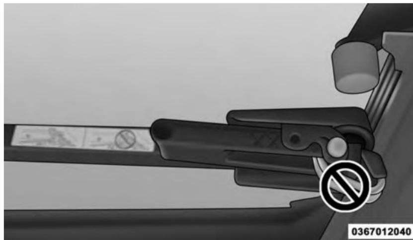
**Improper Clamp Position**
