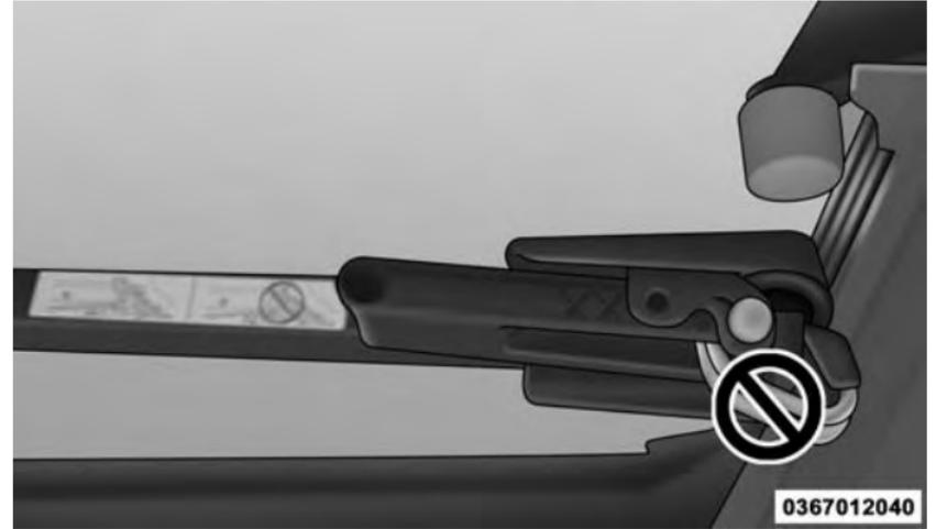
**Improper Clamp Position**
