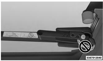
**Improper Clamp Position**
