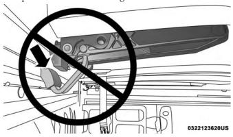
**Improper Clamp Position**
