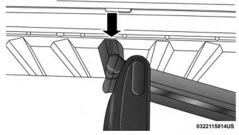
**Aligning Gate To Slots**
