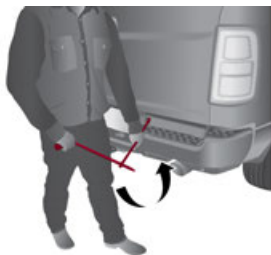
Rotating The Lug Wrench Handle
